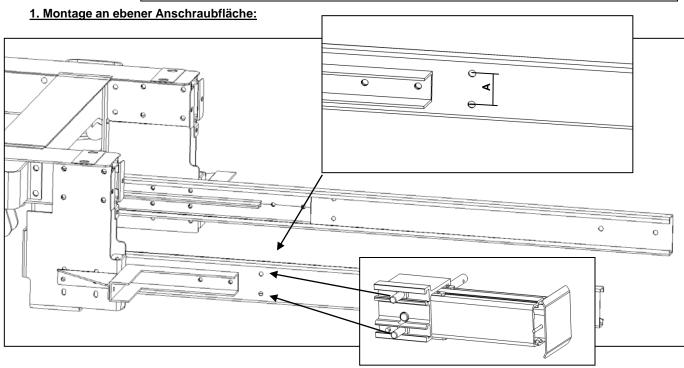
Falls noch keine Bohrungen in der Rahmenverlängerung vorhanden sind, müssen diese noch eingebracht werden. Abstand A= 51mm, Bohrungsdurchmesser 11mm.
